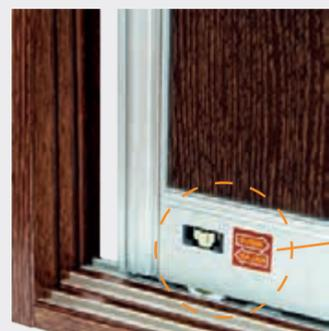
Las puertas se nivelan elevando ligeramente un lateral y accionando el cilindro dentado con un dedo, a izquierda o derecha, según se trate de subir o bajar.
