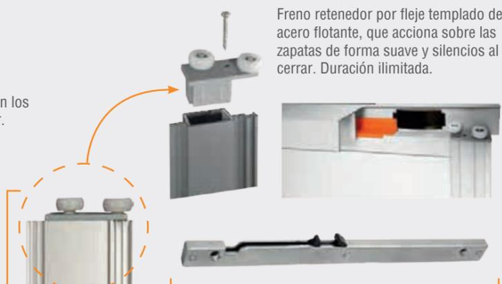
Freno retenedor por fleje templado de acero flotante, que acciona sobre las zapatas de forma suave y silencios al cerrar. Duración ilimitada.
