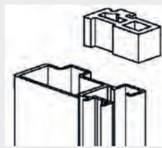
Taco de conexión para unir perfiles horizontales con verticales en las puertas acristaladas. Evita el empleo de tornillos.
