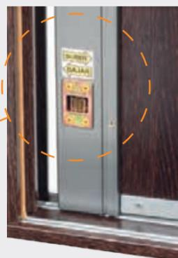
Las puertas se nivelan elevando ligeramente un lateral y accionando el cilindro dentado con un dedo, a la izquierda o derecha según se trate de subir o bajar.
